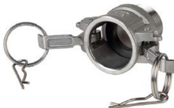
Art. 0410 Fitting Type B: Female Camlock Male Thread ISO 7-1 (EN 10226-1) 1/2"-4"
